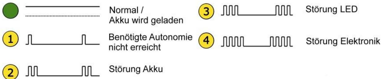
Automatisches Test-System (ATS):
